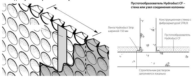
Пустотообразователь Hydroduct CF должен перекрываться внахлёстку на всех швах, склеенных центрально лентой Servitape
